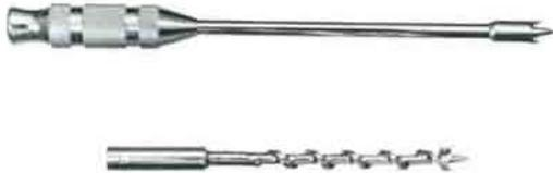
Zur Messung der Innenfeuchtigkeit und des Feuchtigkeitsgefälles in Balken, Bohlen, Schwellen und Masten. Mit dem dazugehörigen Vorbohrer wird die Mess-Stelle auf die gewünschte Messtiefe angebohrt. Zum Anschluss an das Messgerät wird nur das Universal-Messkabel benötigt.
